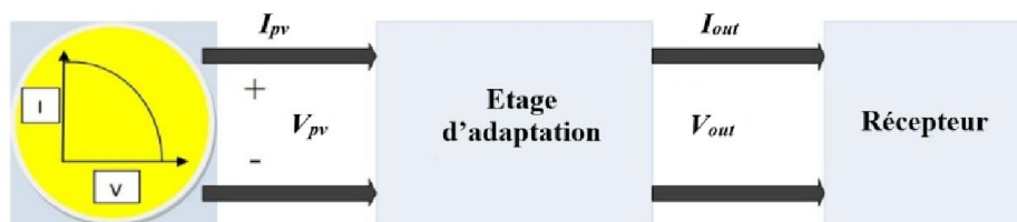
Figure III.2. Étage d'adaptation entre un GPV et un récepteur
