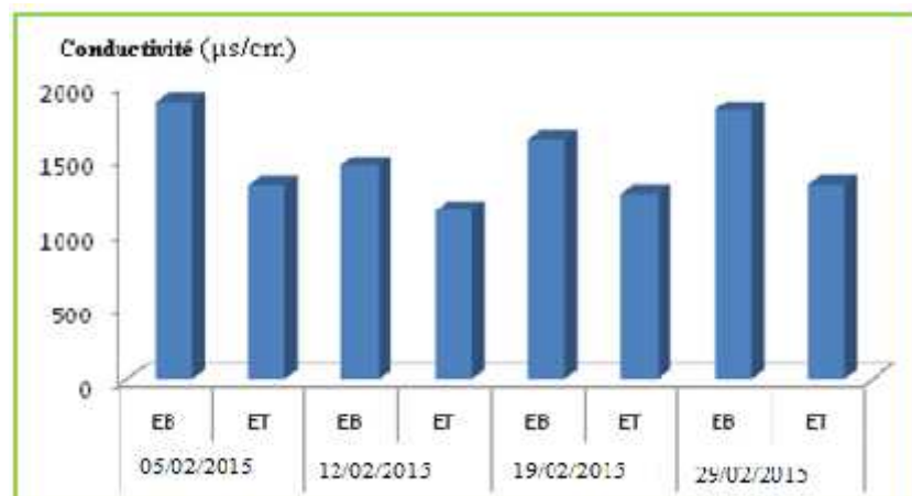
Figure 47 – Valeurs de la conductivité électrique des eaux usées de la STEP de Sidi Bel Abbès.
