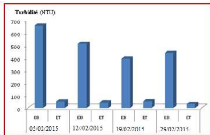
Figure 48 - Evaluation de la turbidité des eaux brutes et épurées de la STEP de Sidi Bel Abbes.
