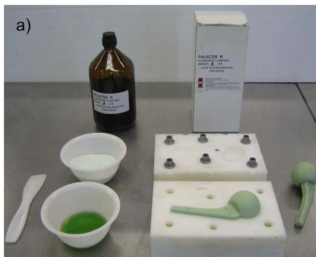
Figure 2-9: poudre (polymère) et liquide (monomère) sont mélangés avec un ratio de 2g :1 ml. Le mélange est versé dans un moule de polyoxyméthylène(POM) pour former le spacer.
