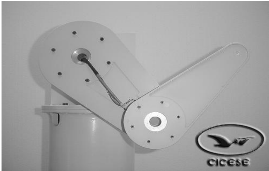
Figure III.2. PELICAN: bras de robot expérimental à CICESE, laboratoire de robotique.
