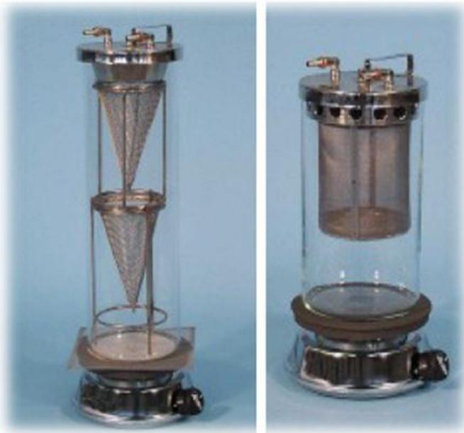
*Fig I-8: L'appareillage de l'essai d'extraction à chaud*
