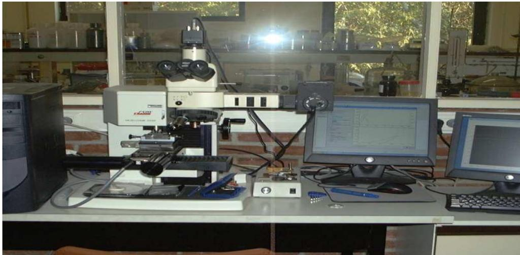
Fig II-2: Appareil d'indentation CSM (16)
