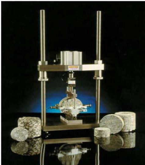
*Fig I-7: appareillage de l'essai Marshall*
