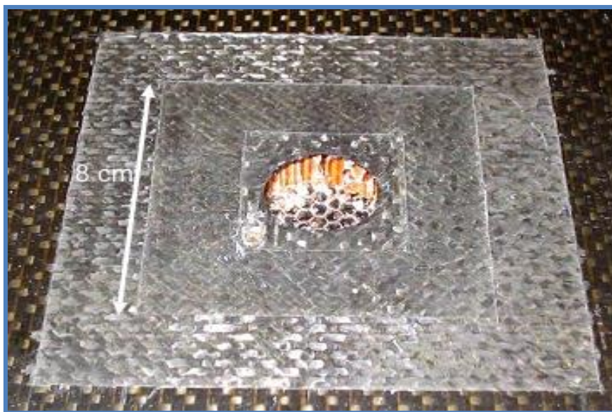
Figure III. 10: Préparation d'une réparation par step sur un composite sandwich ; cette figure est extraite d'un cours de Brunel et présente volontairement des défauts : l'usinage devrait être circulaire si le dommage d'origine est rond et il ne devrait pas y avoir d'angle vif (les coins devraient être arrondis) [31]
