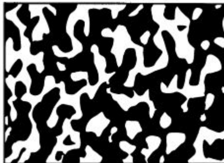
Figure III.2: Une microstructure de squelette d'un matériau FGM (S. S.Vel., R.C. Batra, 2002).
