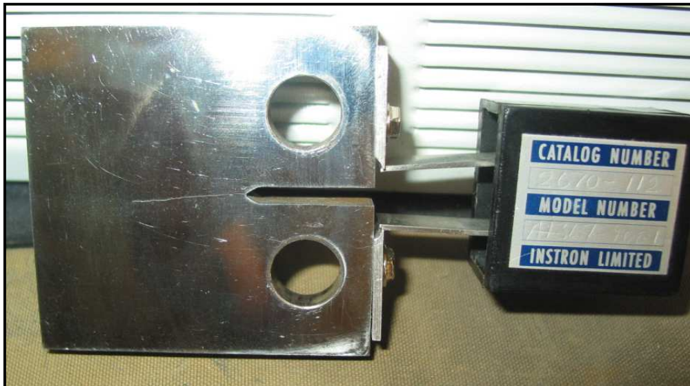
Figure II.6 : Montage du capteur COD
