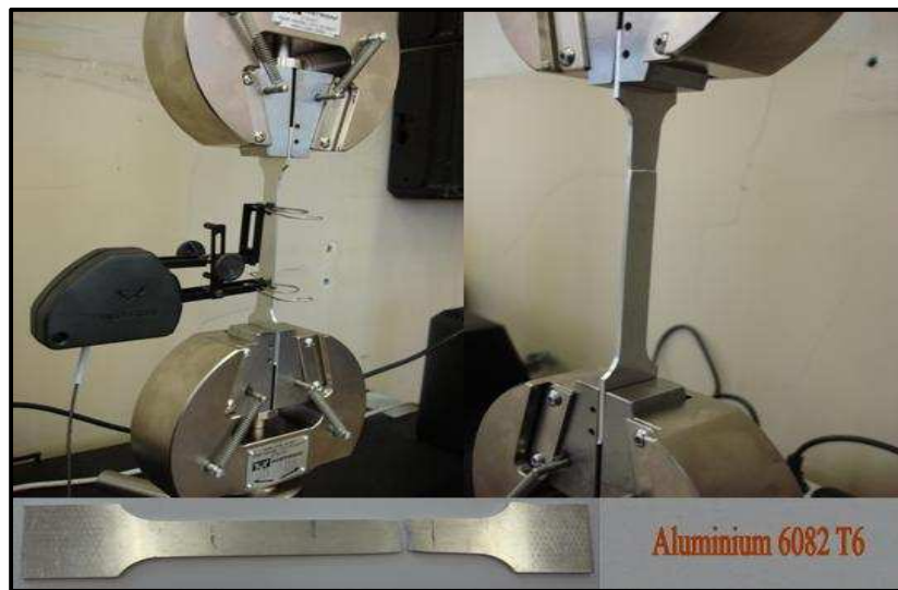
Figure II-2 : Essai de traction d'éprouvette haltère mesuré par l'extensomètre
