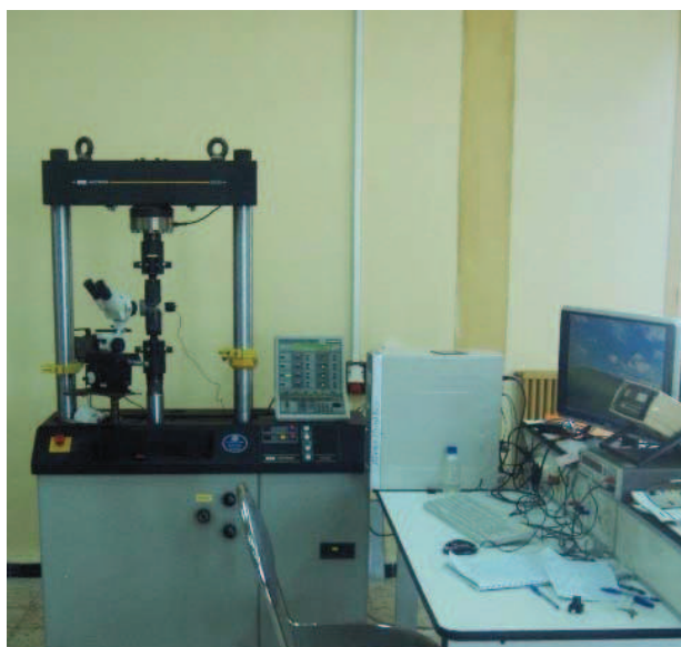
Figure III.6 : Vue d'ensemble du système d'essai de mesure et d'acquisition
