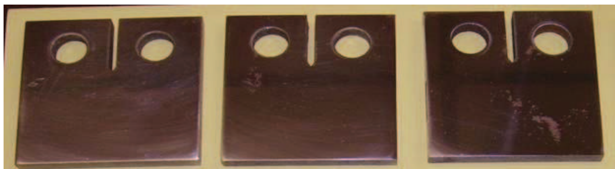
Figure III.4 : Éprouvettes CT50 utilisés pour les essais de fissuration
