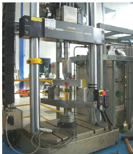
Figure III.15 : Machine d'essai servohydraulique (Instron)
