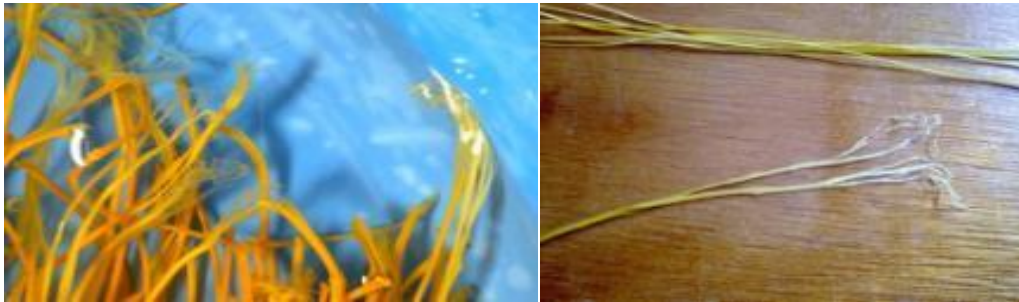
Figure III.8 : Séparation des fibres d'alfa après le traitement chimique.
