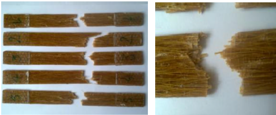
Figure IV.8 : Faciès de rupture du composite polyester-Alfa (Fibres traitées chimiquement : par la soude caustique).
