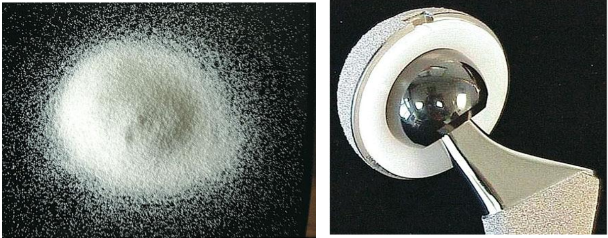
Figure II-4: gauche : « sable » de zircon, droite : une tête de PTH en zirconium
