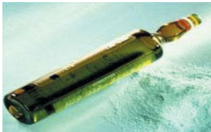
Figure II-11: Composition du liquide : Monomère (méthylmétaacrylate, butyle méthacrylate). Activateur (DmpT : N, N-diméthyl-p-toluidine)
