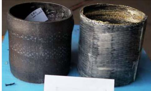
**Figure II- 23:** Mode de flambage extensionnel
