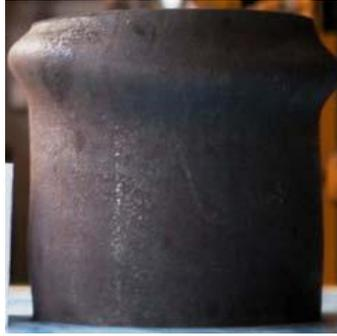
**Figure II-5 :** Mode de flambage « extensionnel » [25]
