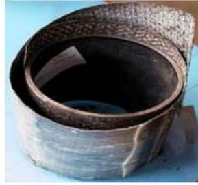
**Figure II- 25 :** Délaminage dû à un chargement localisé sur le TFC
