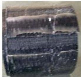
**Figure II- 26 :** L'absence de recouvrement induit un délaminage prématuré
