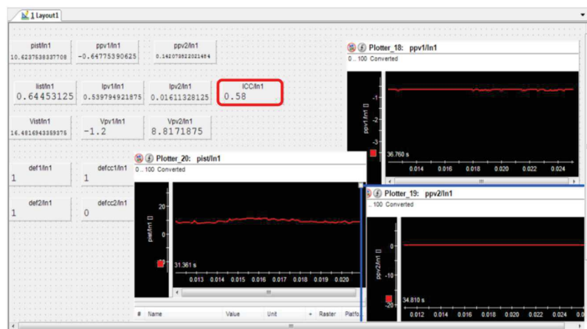
Figure 5. 28 Monitoring via ControlDesk: combinaison d'un SC et d'un défaut d'ombrage.
