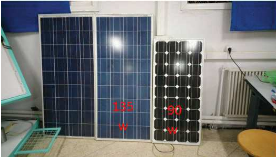
Figure 5. 22 Les deux générateurs PV utilisé 135 W poly-cristallin et 90 W mono-cristallin.
