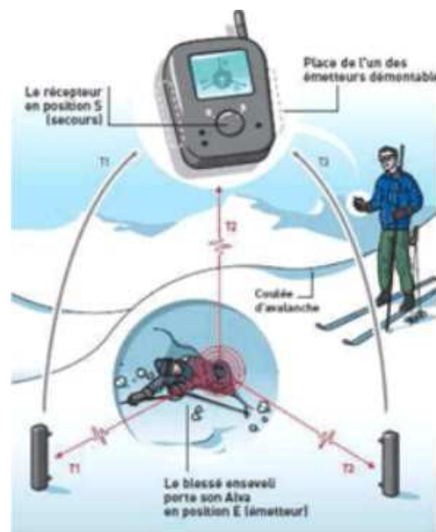
Figure II-55: Détection de personnes ensevelie sous la neige par le système ALVA.
