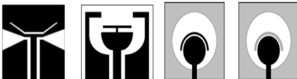
Figure II-45 : Antennes ULB à fréquence rejetée par utilisation de fentes à proximité de l'élément rayonnant [45].
