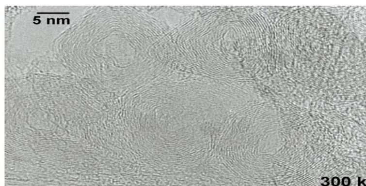
Figure I.12. Coupe transversale (image MET) d'oignons de carbone observés dans un échantillon de nanotubes monocouches (collerette brute produite par arc électrique au GDPC). [31]
