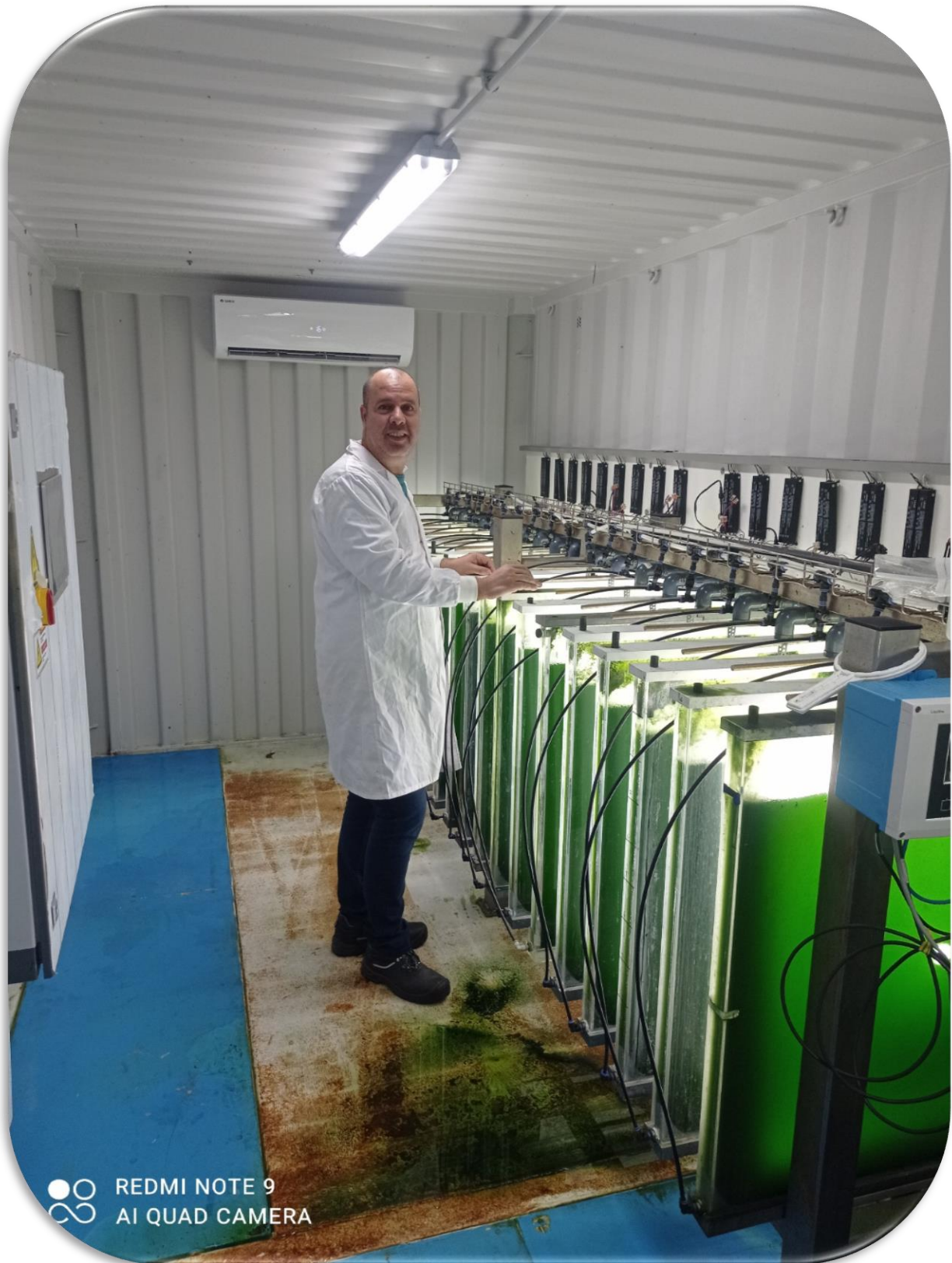
Fig 51 : Disposition Horizontale d'une batterie de Photobioréacteur Plats Port de Saint-Nazaire Nantes (© Doukani 2021)
