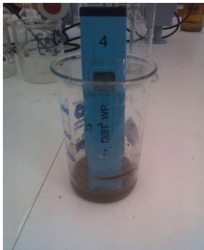
Figure 24 : Mesure de la conductivité électrique (Cliché Merabtene M. 2020).
