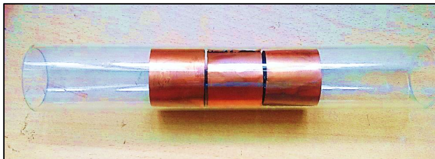
Figure 2.2 Photographie de l'électrode interne en cuivre insérée à l'intérieur de la barrière diélectrique en verre.
