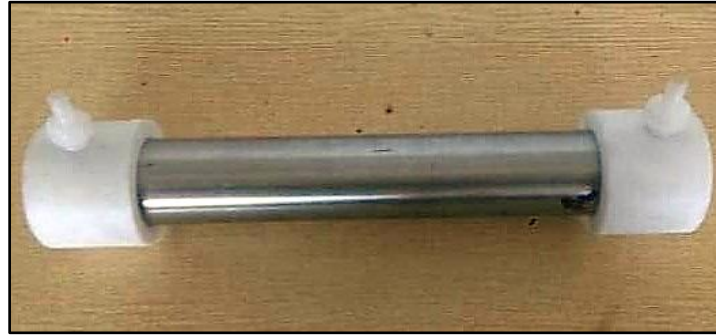
Figure 2.5 Photographie du générateur d'ozone
