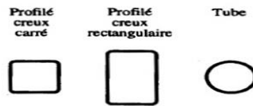
Fig. 1.5 : Exemples des profilés tubulaires [8].
