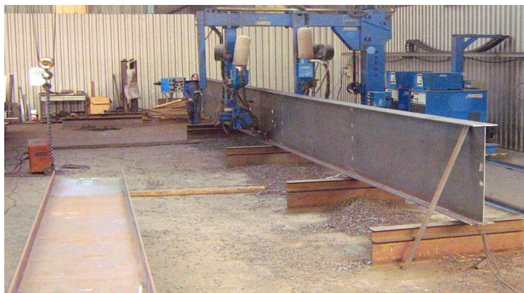
Fig. 1.6 : Profilés reconstitués soudés ( P.R.S ) [12].
