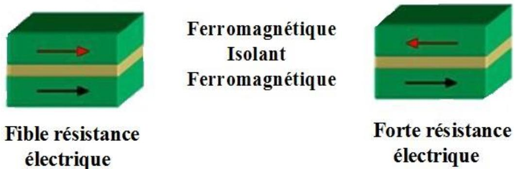
**Figure .I.9.** Les deux états parallèle et antiparallèle dans une jonction tunnel magnétique. [56]
