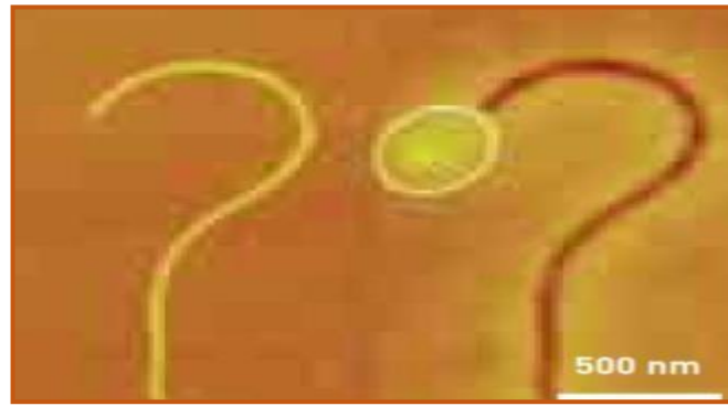
Fig. I.8 : Principe A gauche : image de microscopie à force atomique d'un nanotube de carbone. A droite : image de microscopie à force électrostatique après une expérience d'injection de charges. [1]
