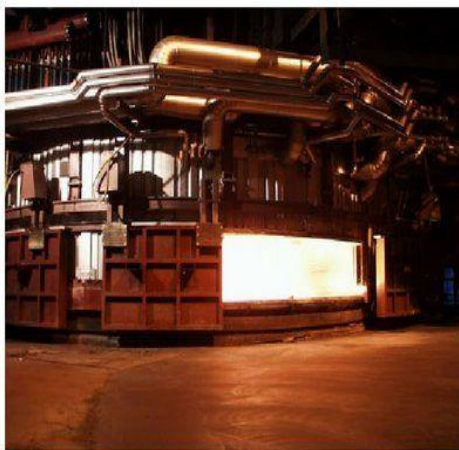
Figure III.2 : Four de production de silicium par voie carbothermique ( gauche ) et représentation schématique d'un four de production de silicium métallurgique ( droite ) [8].
