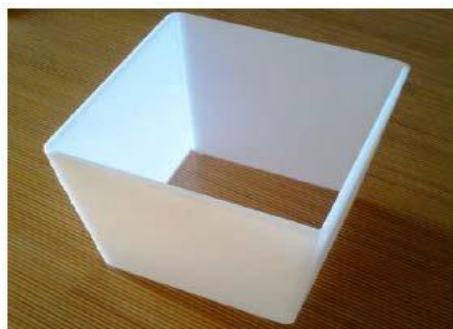
Figure III.7 : Creuset de quartz employé pour réaliser des lingots mc-Si [15].
