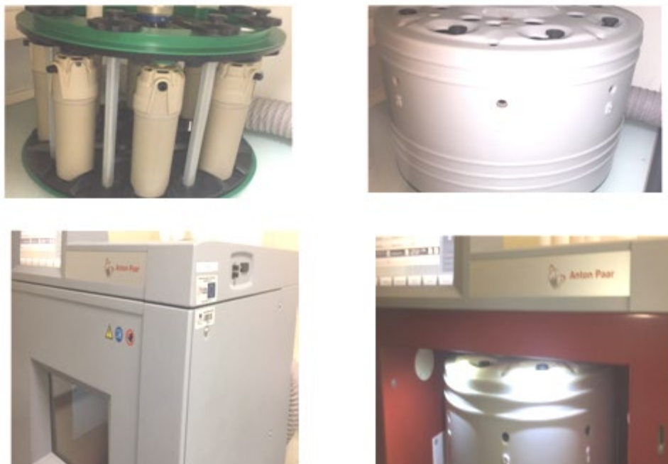
Figure. II.1: Pontage de l'argile sodée par microondes de type (ANTON PAAR PRO Solv 60HZ)- Institut de Chimie des Milieux et Matériaux de Poitiers (IC2MP)
