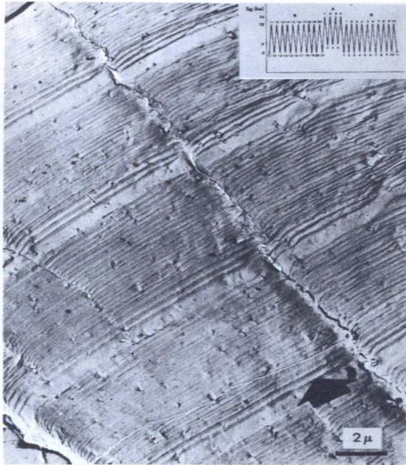
Figure I.14: Surface de rupture par fatigue due à une charge programmée comme indiqué dans l'encart. La strie large est due au cycle de charge B21-A1 suivi par les 3 autres stries dues au programme A [21]
