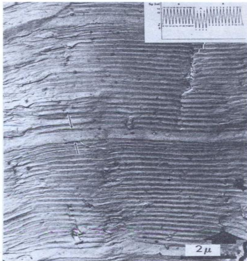
Figure I.15: Surface de rupture par fatigue due à la charge programmée comme indiqué dans l'encart. La strie large due au cycle A4-B1 est précédée de 3 stries plus petites dues au spectre A.
