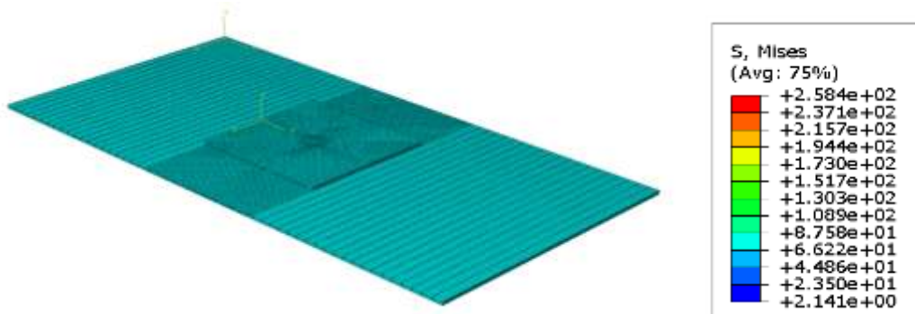
Figure III.7 : Niveau de contraintes dans l'ensemble (Plaque+adhésif+ patch) pour le troisième maillage.
