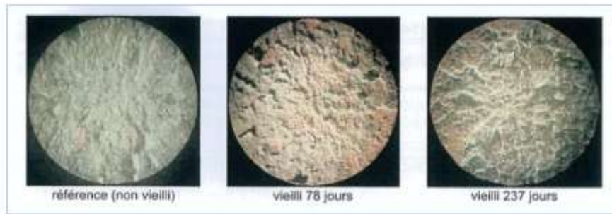
Figure I.21: Evolution du faciès de rupture après vieillissement hygrothermique d’assemblages avec des substrats en aluminium [32 ].
