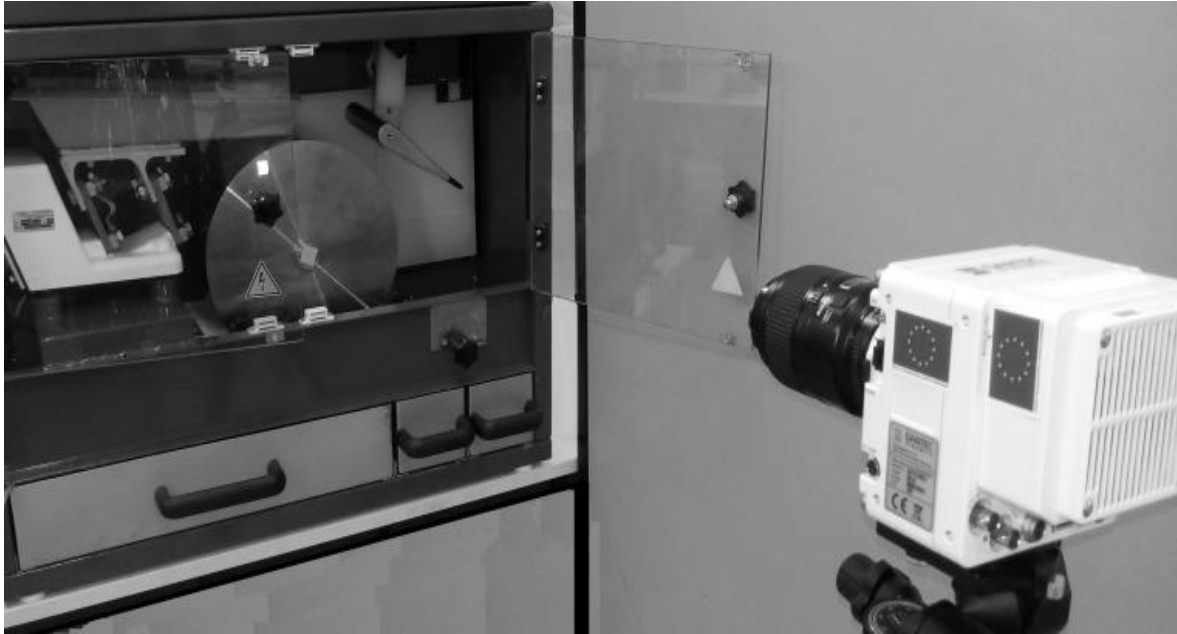
Figure 4. 7. Disposition du séparateur électrostatique Prodecologia et de la caméra vidéo à haute vitesse SpeedSense.
