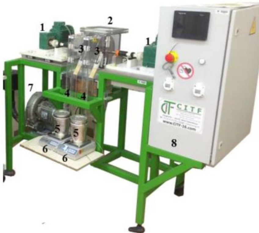
Figure 1.14. Photographie d'un séparateur tribo-aéro-électrostatique à disques (1) Moteurs électriques ; (2) Chambre de séparation ; (3) Electrodes-disques tournants ; (4) Collecteurs ; (5) Cages de Faraday ; (6) Balances électroniques ; (7) Turbine ; (8) Armoire électrique
