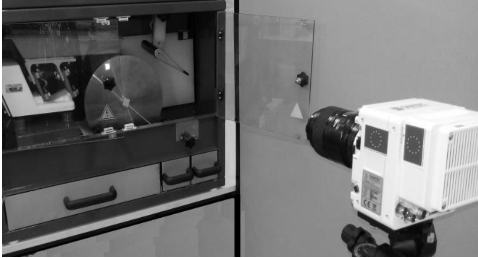
Figure 2.6. Disposition du séparateur électrostatique Prodecologia et de la caméra vidéo à haute vitesse SpeedSense.
