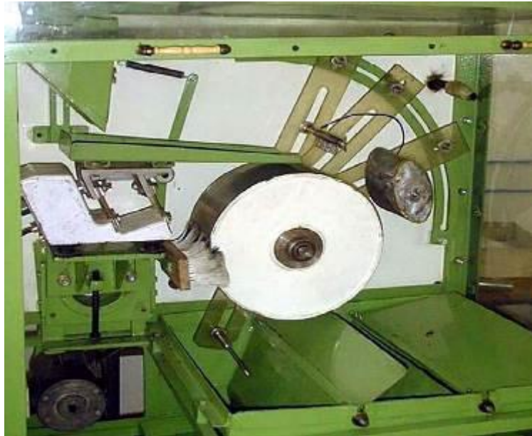
Figure 1.16 : Séparateur électrostatique à cylindre tournant SELMEG (Laboratoire IRECOM ; Université de Sidi Bel Abbese ; Algérie)
