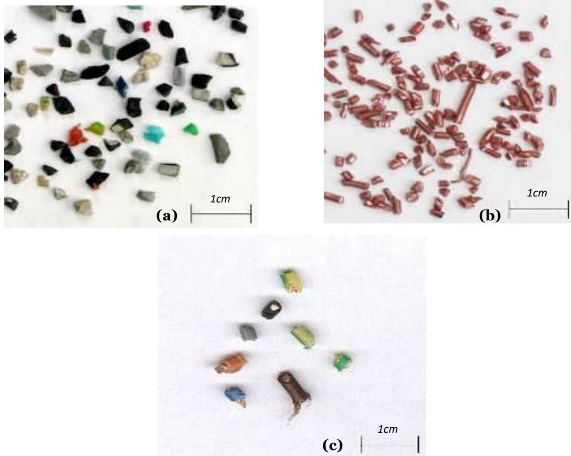
Figure 1. 7. Déchet de câble électrique récupéré à la sortie d'un broyeur (a-b) : granules homogènes ; (c) : granules hétérogènes
