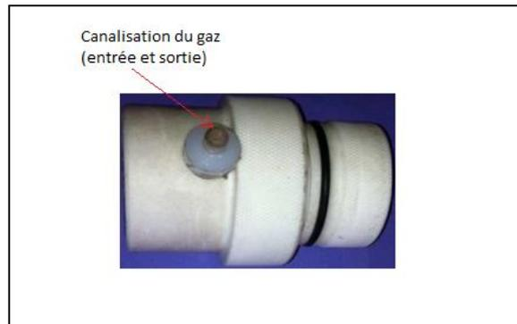
Figure 3.11. Photographie du bouchon de centrage en téflon
