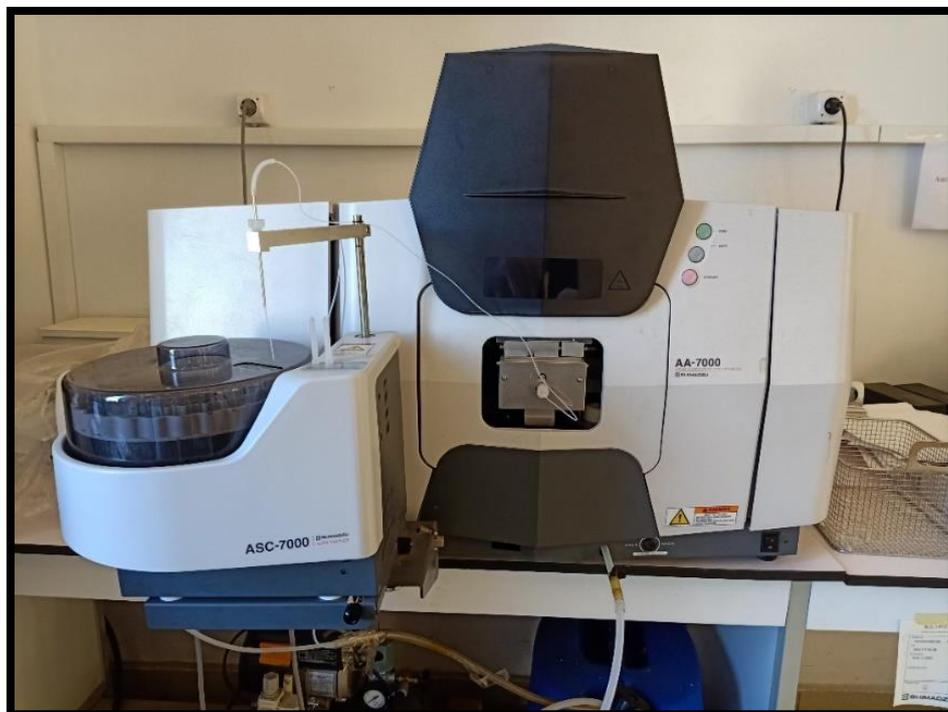
**Spectrophotomètre d'absorption atomique**
