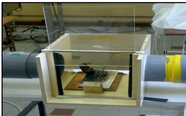
Figure II.12 : Photographie du générateur de fumée et support de fixation des cigarettes et encens.
