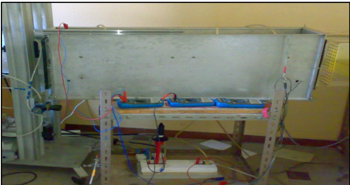
Figure II.10 : Photographie réelle du précipitateur électrostatique principal
