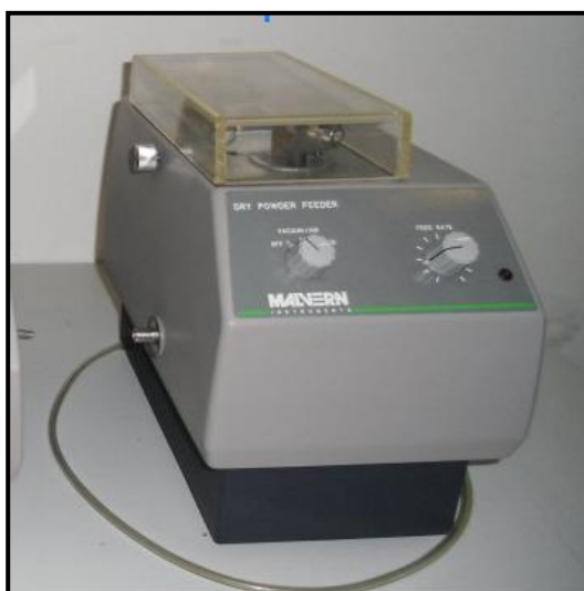
Figure II.13 : Photographie de l'appareil d'injection de la poudre
