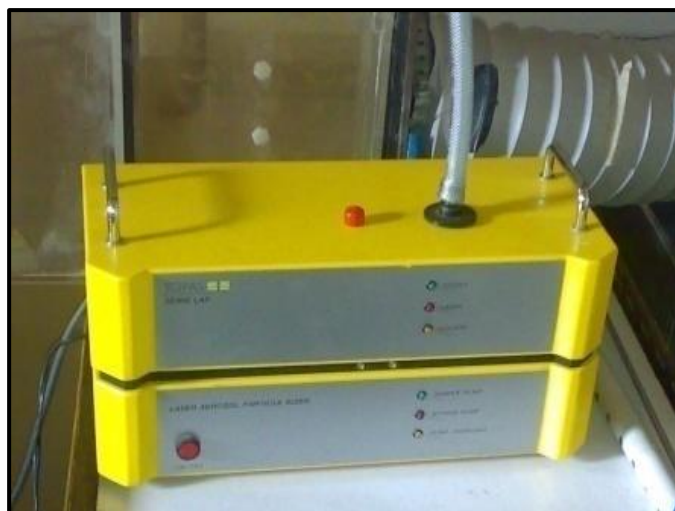
Figure II.16 : Granulomètre laser modèle LAP 320 – marque TOPAS
