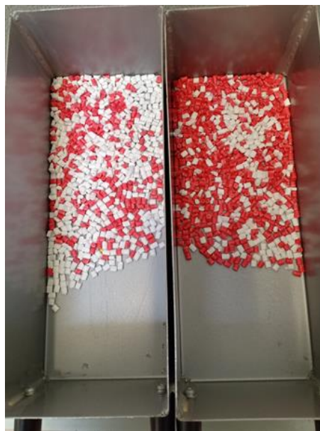
Figure V.8. Résultats de séparation du mélange PP bromé et PP non-bromé. (Parois en PS, t = 5 \text{ min} , U = 36 \text{ kV} , \alpha = 30^\circ , n = 35 \text{ tr/min} , \beta = -11^\circ , Q = 2,5 \text{ g/s} ).
