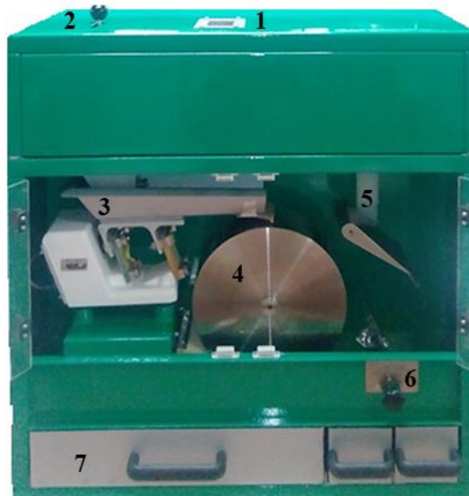
Figure II.12. Photographie de l'installation de séparation : (1) trémie d'alimentation du chargeur ; (2) système d'ouverture/fermeture de la trappe du chargeur ; (3) goulotte oscillante ; (4) électrode cylindrique tournante reliée à la terre ; (5) électrode statique reliée à une source de haute tension ; (6) système de réglage de l'inclinaison du volet défecteur ; (7) collecteurs à trois compartiments.
