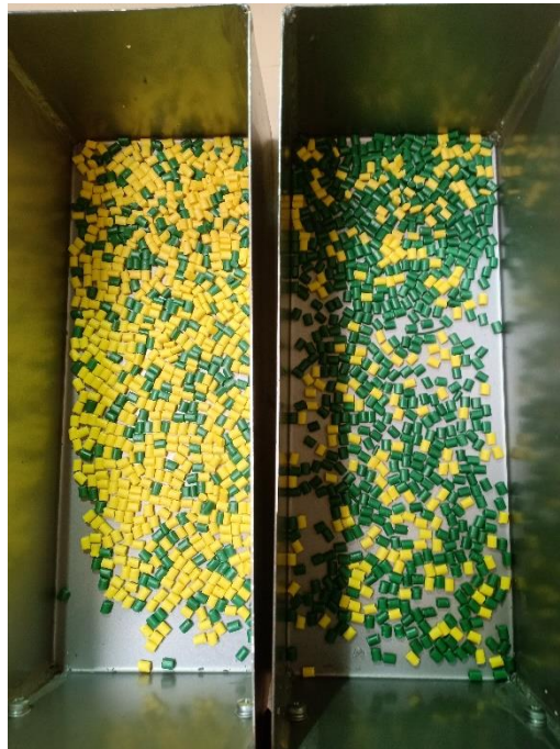
Figure V.4. Résultats de séparation du mélange HIPS bromé et HIPS non-bromé. (Parois en PP, t = 5 min, U = 36 kV, \alpha = 30^\circ , n = 35 tr/min, \beta = -11^\circ , Q = 2,5 g/s).
