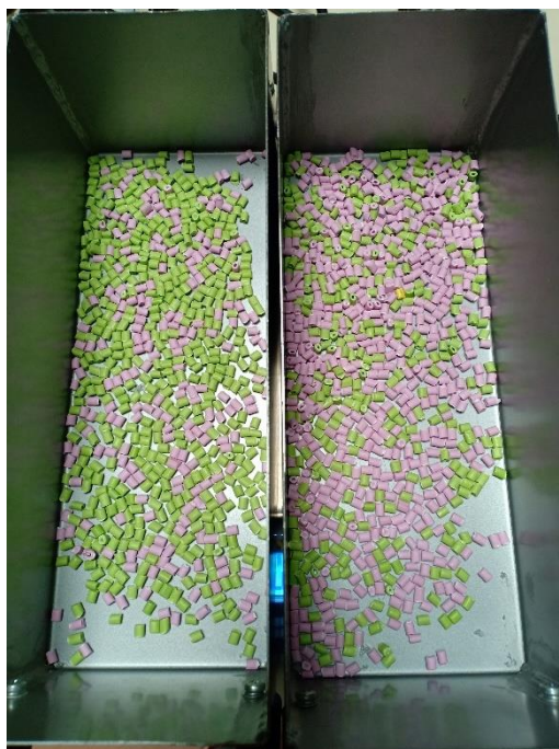
Figure V.6. Résultats de séparation du mélange PE bromé et PE non-bromé. (Parois en PS, t = 5 min, U = 36 kV, \alpha = 30^\circ , n = 35 tr/min, \beta = -11^\circ , Q = 2,5 g/s).
