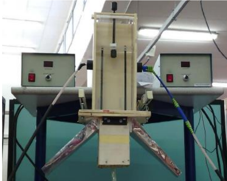
Figure I.20. Photographie du dispositif de triboélectricité à électrodes verticales.
