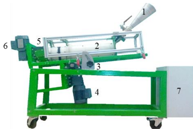
Figure II.10. Dispositif de charge à cylindre tournant : (1) entonnoir pour alimenter le produit ; (2) cylindre extérieur ; (3) système de réglage de l'inclinaison du cylindre ; (4) moteur d'entraînement du cylindre extérieur ; (5) trémie de récupération du produit chargé ; (6) moteur d'entraînement du cylindre intérieur ; (7) armoire électrique.
