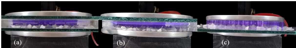
Figure IV.7. Photographies de la DBD pour les trois arrangements de barrières : (a) Les deux électrodes couvertes par un diélectrique ; (b) L'électrode supérieure est couverte par le diélectrique et (c) L'électrode inférieure est couverte par le diélectrique.
