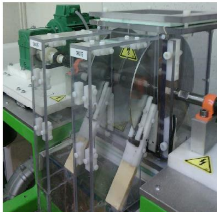
Figure I.19. Photographie du dispositif tribo-aéro-électrostatique à disques tournants.
