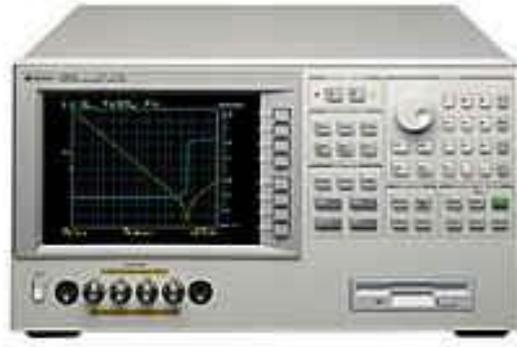
Figure II.2: Pont d'impédance Agilent.
