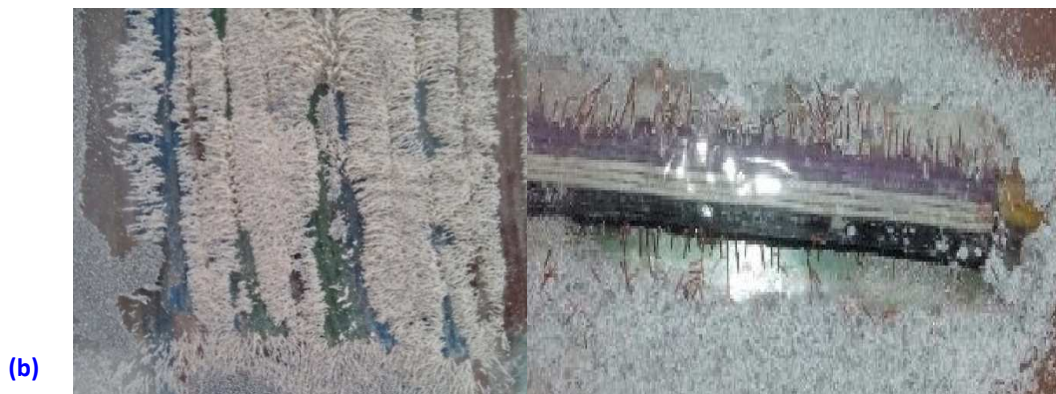
Figure 3-14 – (a) Dessin explicatif des lignes du champ électrique, (b) Photographie illustrant les lignes du champ électrique.
