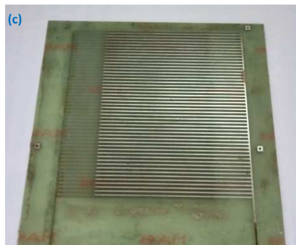
Figure 3-1 –Convoyeur à double face utilisé (a)Schéma descriptif du convoyeur avec les dimensions en mm, (b)Convoyeur simulé par logiciel " ISIS Ares ", (c)Photographie du convoyeur à double face.
