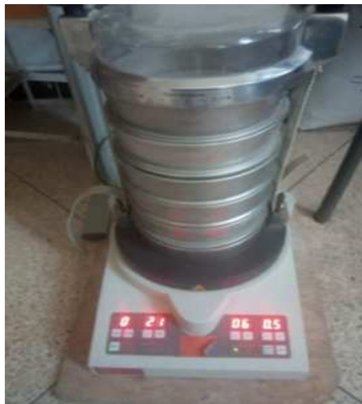
Figure 3-2 - Photographie du tamiseur à vibrations FRITSCH.
