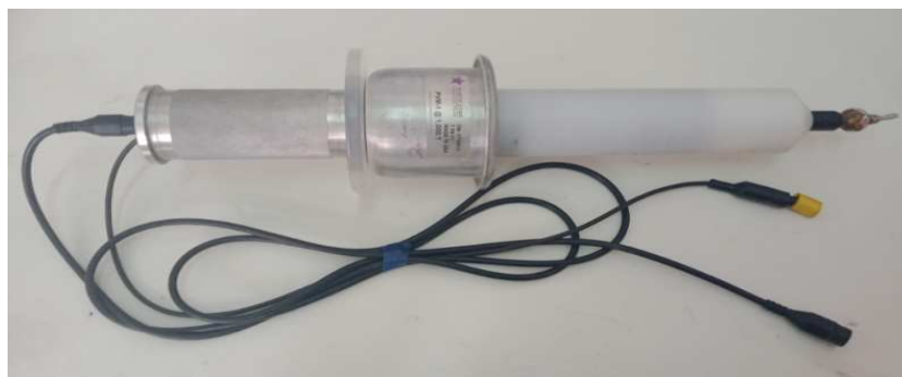
Figure 2-11– Sonde haute tension utilisée.
