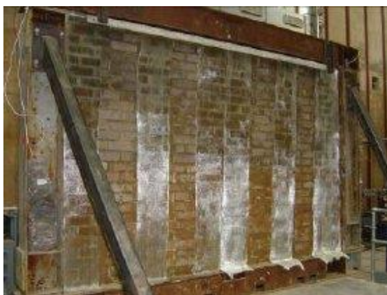
Fig.1.17 : Renforcement des murs par coulage de tissus.
