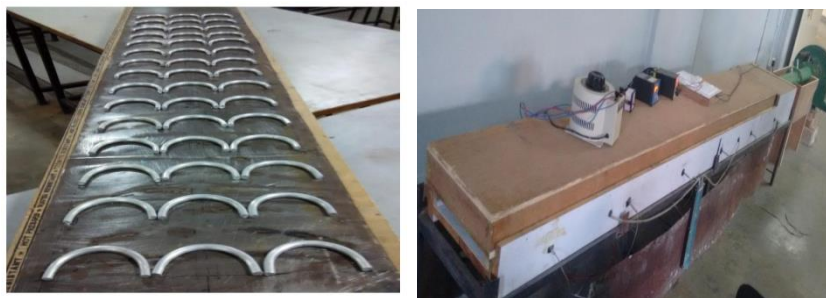
Figure. I.34: (a)Géométrie de rugosité (b) Montage expérimental [36].
