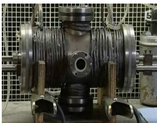
Figure I.10 : Schéma d'un réacteur de synthèse de nanotubes de carbone par la méthode de l'arc électrique [Marcoux 2002].
