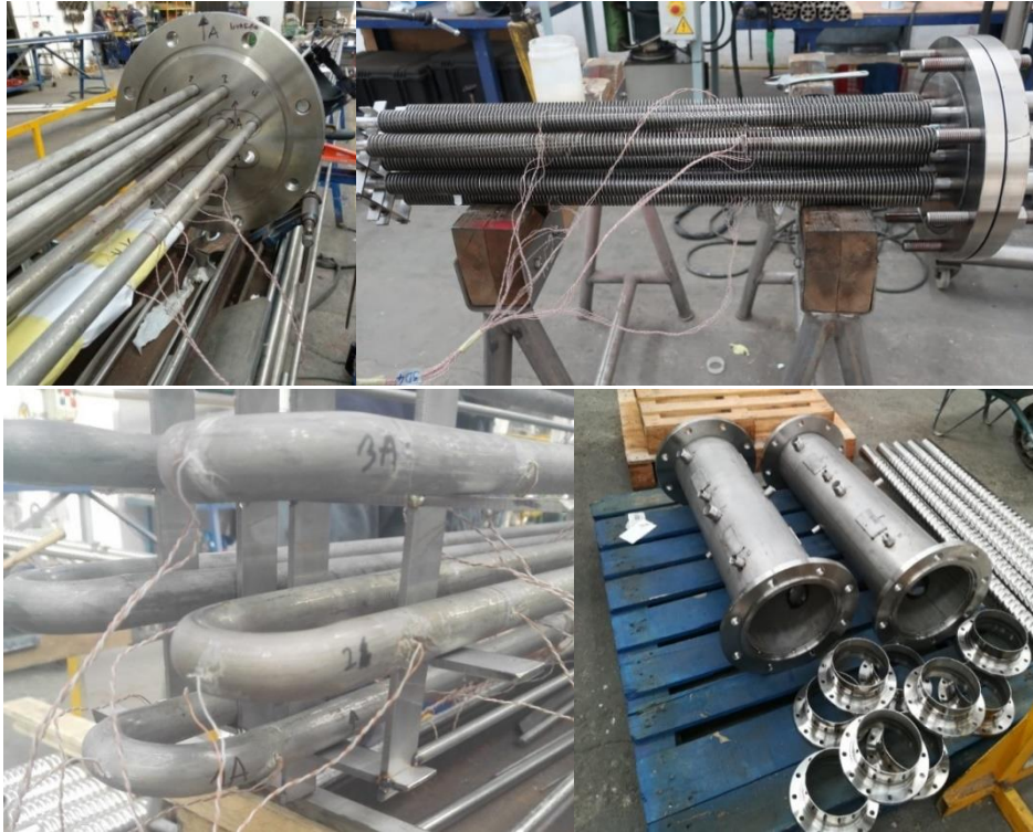
Figure 4.13 Assemblage des accumulateurs.
