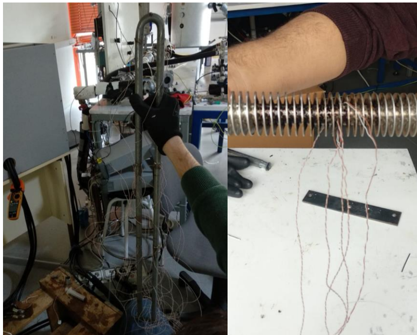
Figure 4.12 Thermocouples correctement soudés.
