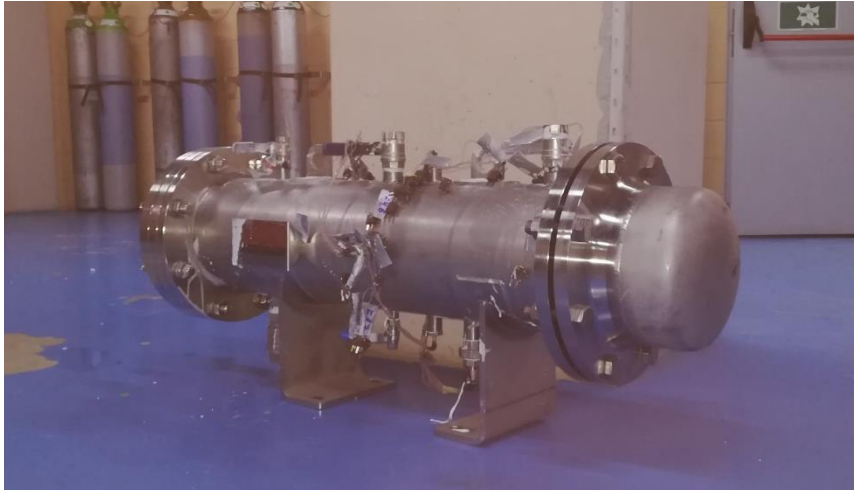
Figure 4.5 Accumulateur à tubes lisses instrumenté, monté et préparé pour le remplissage en paraffine.
