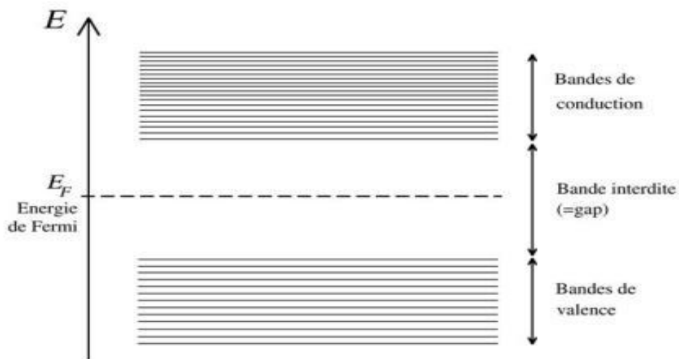
Figure III.3 : Bandes de valence, bandes de conduction, bande interdite et le niveau de Fermi.
