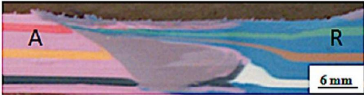
Figure 1.35: Soudage des plasticines, composition rhéologique d'un cordon de soudure (différentes couleurs de plasticines) [Nejah.06].
