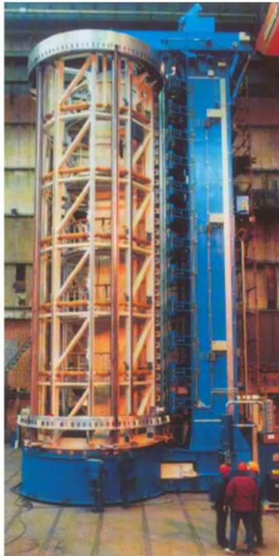
Figure 1.11 : Réservoir cryogénique chez Boeing Space [Baptiste .05].
