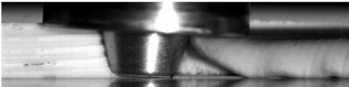
Figure 1.34 : Image extraite du film de l'écoulement de la matière dans la plasticine [Gratecap .44].
