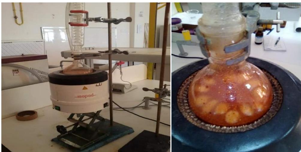
**Figure 20 :** Chauffage à reflux
