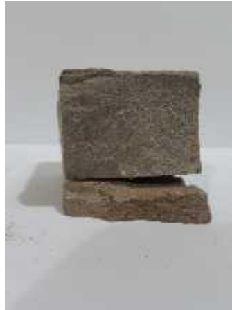
Figure VI.10 : séparation de la couche de renforcement GP1 et GP2 par rapport au béton de l'éprouvette.
