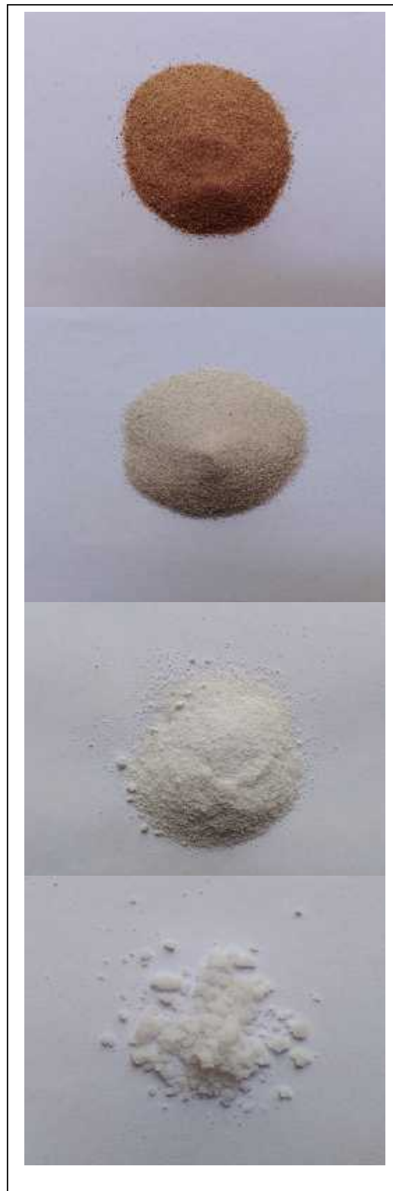
Figure VII.1 : procédure chimique d'extraction du silicium.
