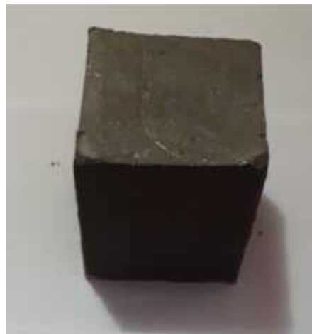
Figure VI.1 : éprouvette cubique de 10 \times 10 \times 10 \text{ cm}^3
