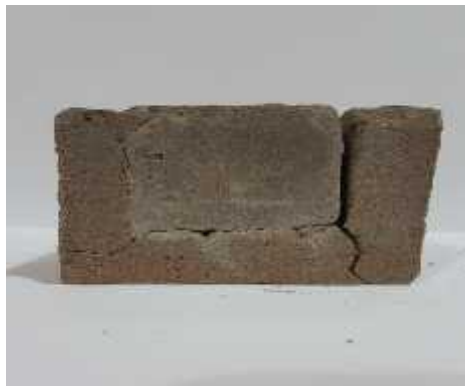
Figure VI.7 : Séparation de la couche de renforcement GP1, GP2, GP3 et GP4 par rapport au béton de l'éprouvette.
