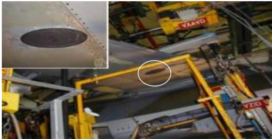
Figure V.3 : Réparation par collage de patch composite sur une aile d'avion.
