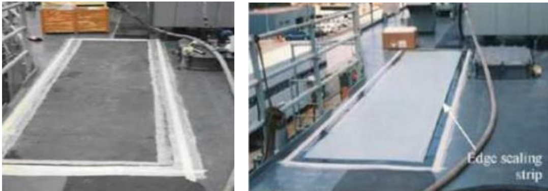
Figure V.5 : Réparation de superstructure d'un navire en aluminium par patch composites.
