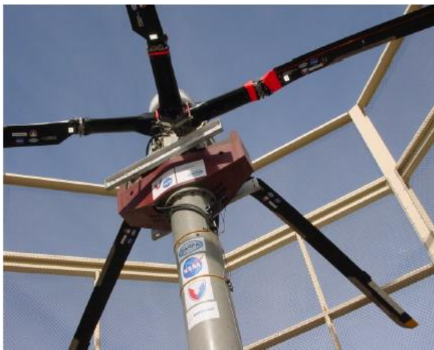
Figure II.7 : Contrôle actif des vibrations d'une pale d'hélicoptère (Bendine 2016).
