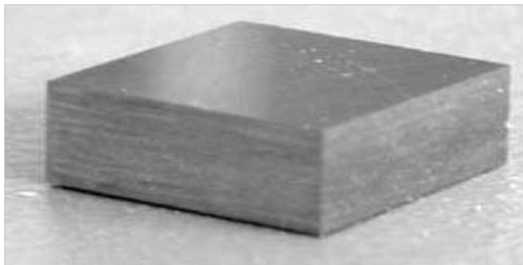
Figure 1.26 Une plaque fonctionnellement graduée.(mechanics of functionally graded material structures)
