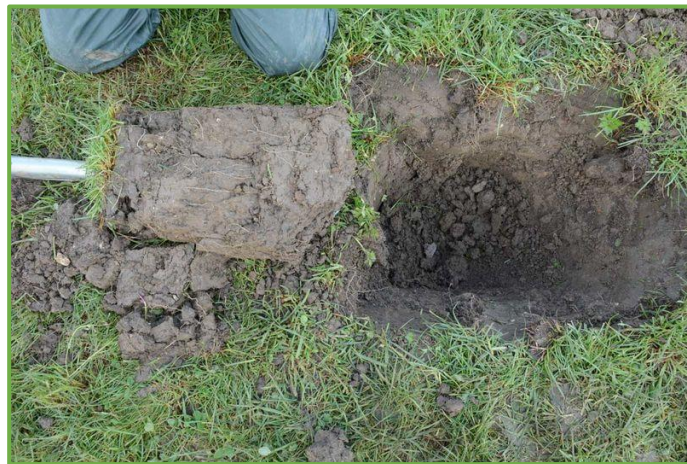
Figure 48 : essai de dégradation de l'enfouissement au sol.
