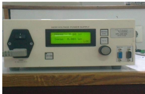
Figure(II.2): Photographie de l'alimentation haute tension de laboratoire utilisé
