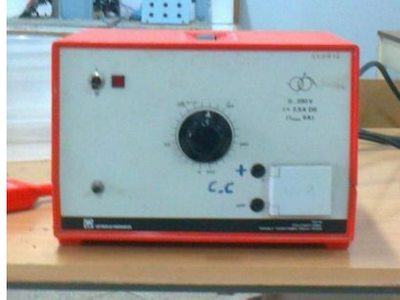
Figure (II.5): Photographie d'un autotransformateur
