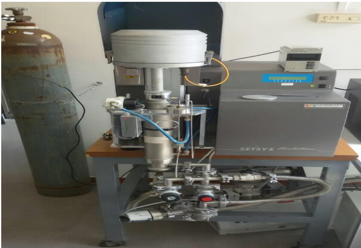
Figure 4.1.4. Montage des mesures thermique (ATG-DTG) par Setaram Setsys 1200 T.
