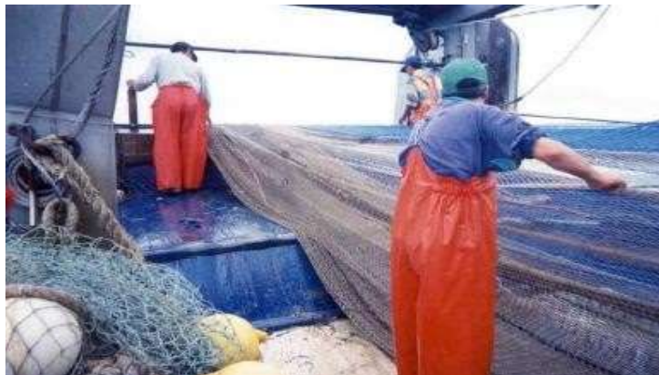
Fig. 29 - Opération de filage du chalut
