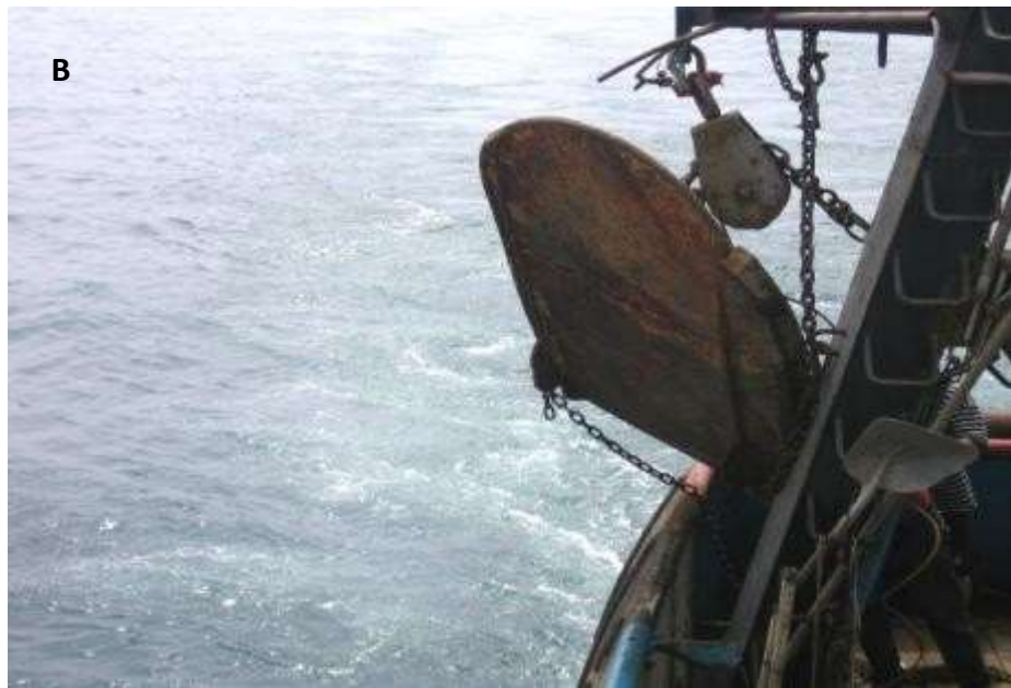
Fig. 30 – A : Virage des panneaux B : Accrochage des panneaux
