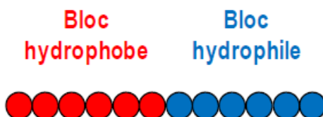
Figure III-1 : Structure générale d'un copolymère diblocs amphiphile
