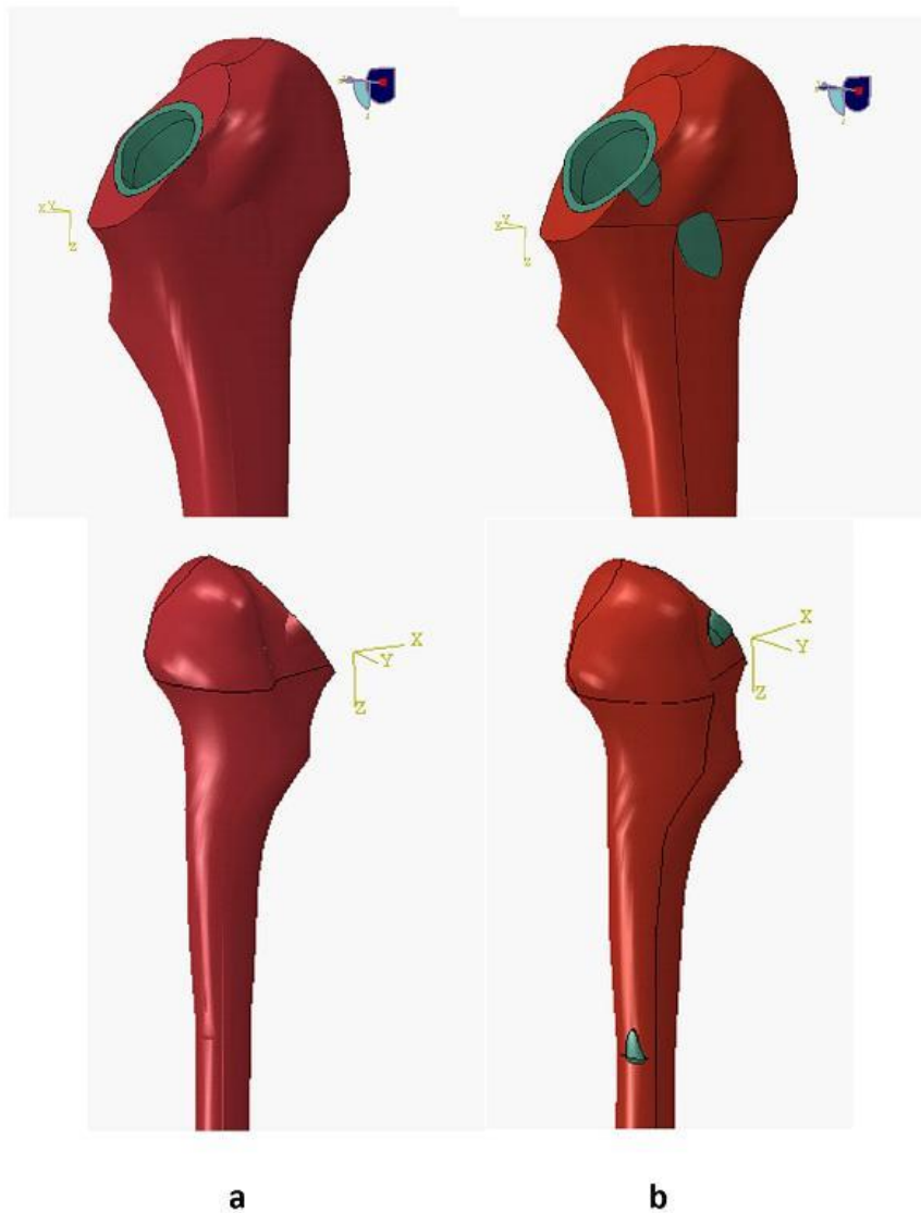
Figure 3.8 : Modèles: sans zones de contact (a) avec Zones de contact du ciment avec l'os cortical (b).
