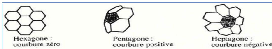
Figure II-17 Influence du type de cycle sur la courbure de la surface. [Marcoux 2002].
